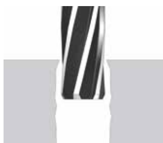
Mauvaise qualité de surface
