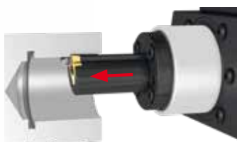
2 Herramienta de corte dentro de la pieza.
