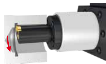
3 Herramienta de corte se eleva de la pieza
